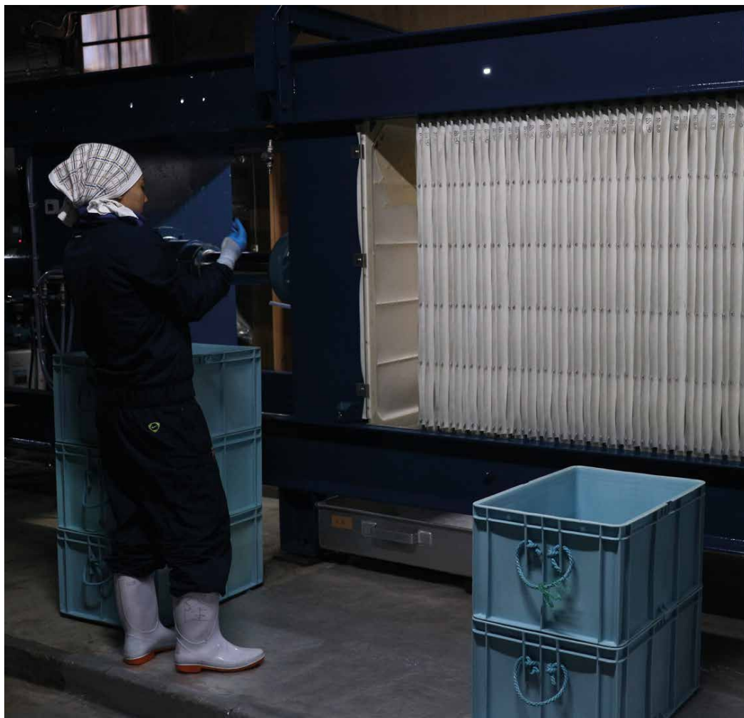
Machine à pressurage à la brasserie Fujii
